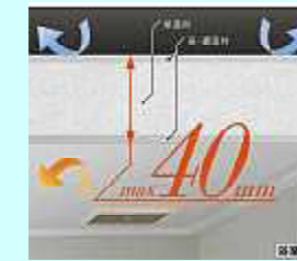
エコサンドイッチ天井 温かい空気を逃がさない
